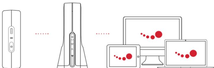
La DEL d'alimentation passera du clignotement rouge à un état fixe blanc lorsque l'appariement de CameraLink à SlingStudio a réussi. Ces deux dispositifs se connecteront automatiquement l'un à l'autre par la suite.
